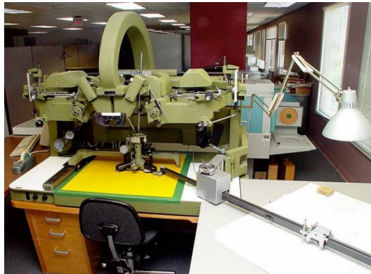
Εικ. 5: Αναλογικός στερεοανα-γωγέας. Με τη χρήση ζευγών φωτογραφιών, επιτυγχάνεται η παρατήρηση και ο προσδιορισμός κάθε σημείου ενός χώρου ή αντικειμένου. Με ένα αρκετά πολύπλοκο μηχανικό σύστημα, ο χειριστής είχε τη δυνατότητα να σχεδιάσει το περίγραμμα χώρων, αντικειμένων και την απόδοση σχεδίων (κυρίως χαρτών).
