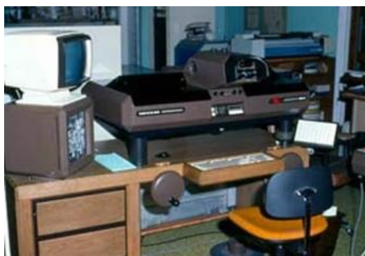
Εικ. 6: Αναλυτικός στερεαναγωγέας. (τύπος Wild BC-2 Analytical Stereoplotter).
