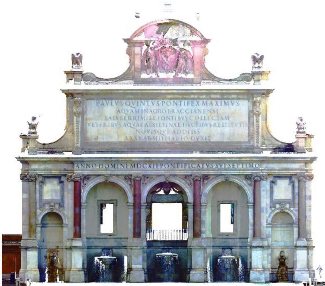
Εικ. 3: Παράδειγμα δημιουργίας ορθοφωτογραφίας υπό κλίμακα, γεωμετρικά ταυτιζόμενη με την κύρια όψη του μνημείου (Fontana dell' Acqua Paola, Ρώμη, πηγή: αρχείο EMP/TAM/ΔΠΘ).
